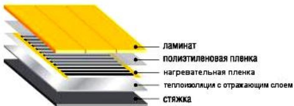
Рисунок И.3 – Слои пола при установке нагревательной секции на основе нагревательной пленки
