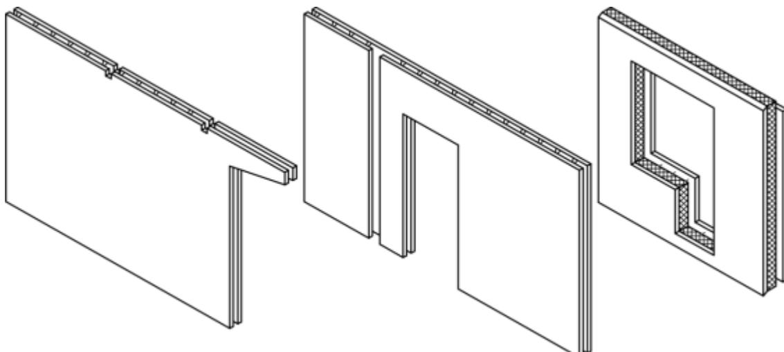
Рисунок 1 – Конструкция сборных железобетонных элементов несъемной опалубки
