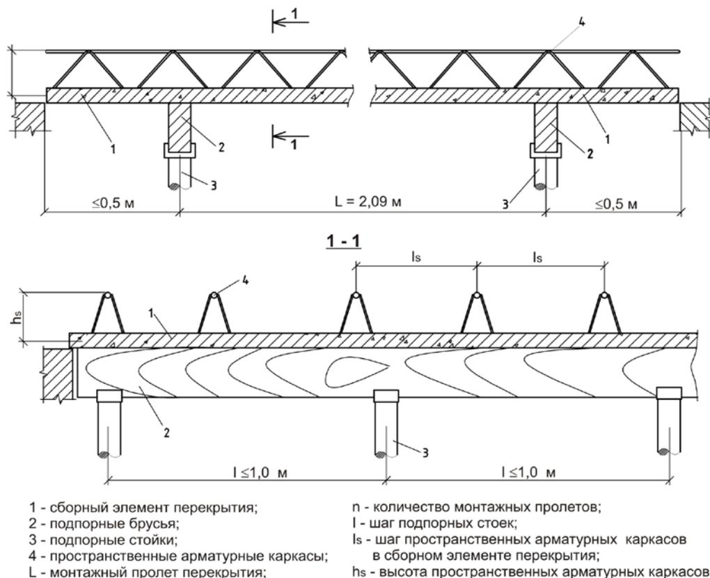
$l$  – сборный элемент перекрытия; 2 – подпорные брусья; 3 – подпорные стойки; 4 – пространственные арматурные каркасы;  $L$  – монтажный пролет перекрытия;  $n$  – количество монтажных пролетов;  $l$  – шаг подпорных стоек;  $l_s$  – шаг пространственных арматурных каркасов в сборном элементе перекрытия;  $h_s$  – высота пространственных арматурных каркасов
