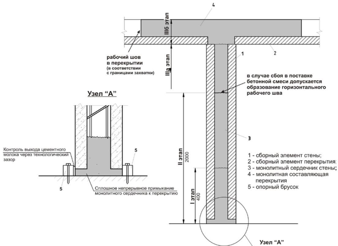
1 – сборный элемент стены; 2 – сборный элемент перекрытия; 3 – монолитный сердечник стены; 4 – монолитная составляющая перекрытия; 5 – опорный брусок
