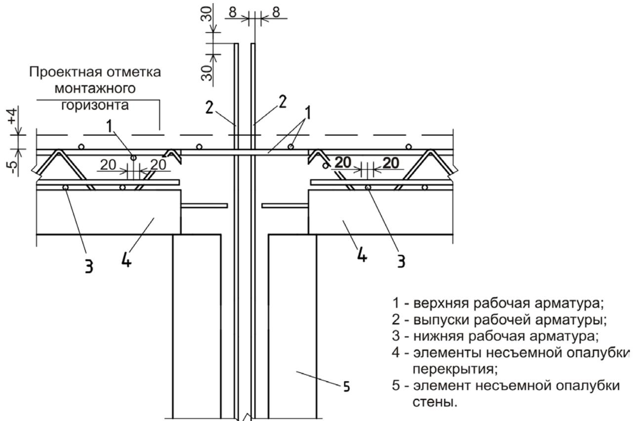
1 – верхняя рабочая арматура; 2 – выпуски рабочей арматуры; 3 – нижняя рабочая арматура; 4 – элементы несъемной опалубки перекрытия; 5 – элемент несъемной опалубки стены
