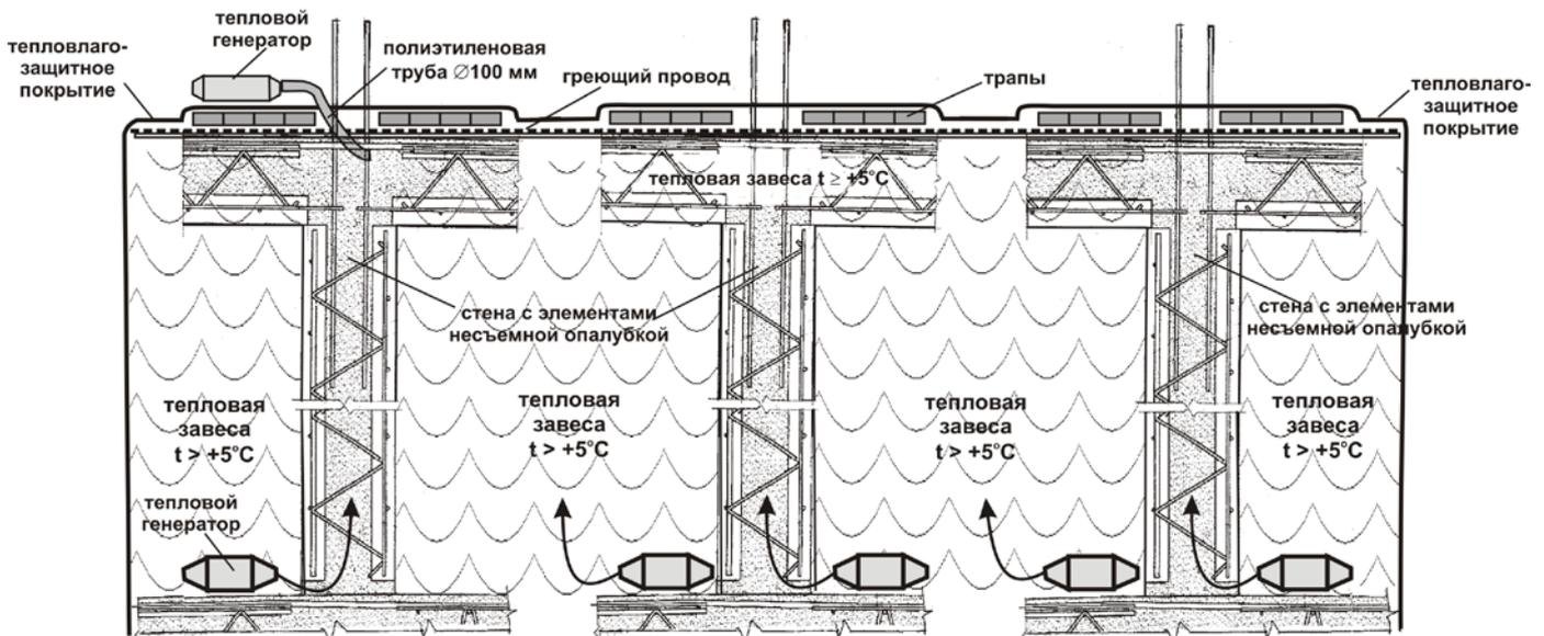
Рисунок 12 – Схема прогрева конструкций
