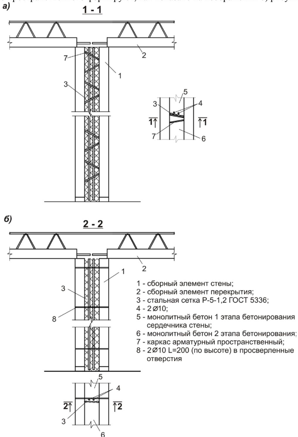
1 – сборный элемент стены; 2 – сборный элемент перекрытия; 3 – стальная сетка Р-5-1,2 ГОСТ 5336; 4 – 2 Ø 10; 5 – монолитный бетон 1 этапа бетонирования сердечника стены; 6 – монолитный бетон 2 этапа бетонирования; 7 – каркас арматурный пространственный; 8 – 2 Ø 10 L = 200 (по высоте) в просверленные отверстия
