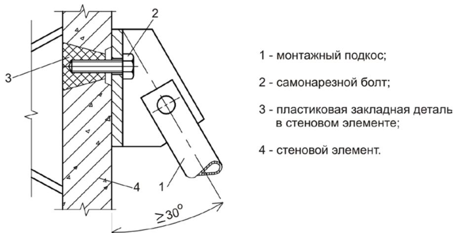
1 – монтажный подкос; 2 – самонарезной болт; 3 – пластиковая закладная деталь в стеновом элементе; 4 – стеновой элемент
