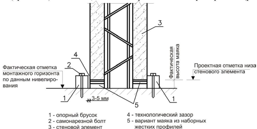
1 – опорный брусок; 2 – самонарезной болт; 3 – стеновой элемент; 4 – технологический зазор; 5 – вариант маяка из наборных жестких профилей
