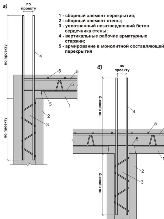
а) сопряжение с наружной или внутренней стеной; б) сопряжение с внутренней стеной
