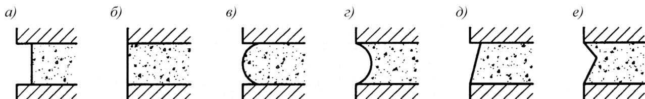
а) – втопленный; б) – в подрезку; в) – выпуклый втопленный; г) – вогнутый; д) – односрезный;
