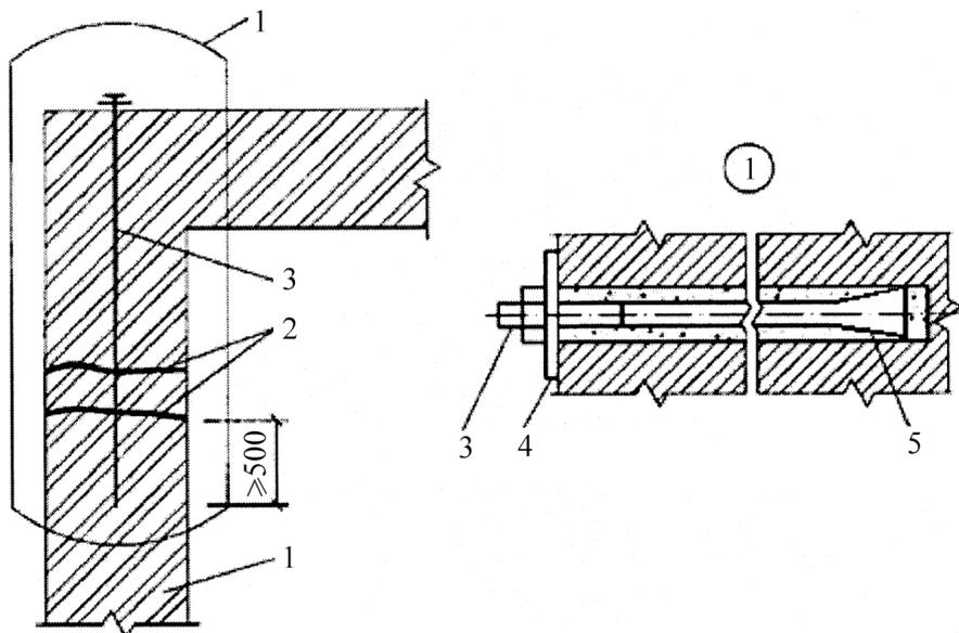
1 – усиливаемая стена; 2 – трещины в кладке стены; 3 – внутренний клиновой анкер;
