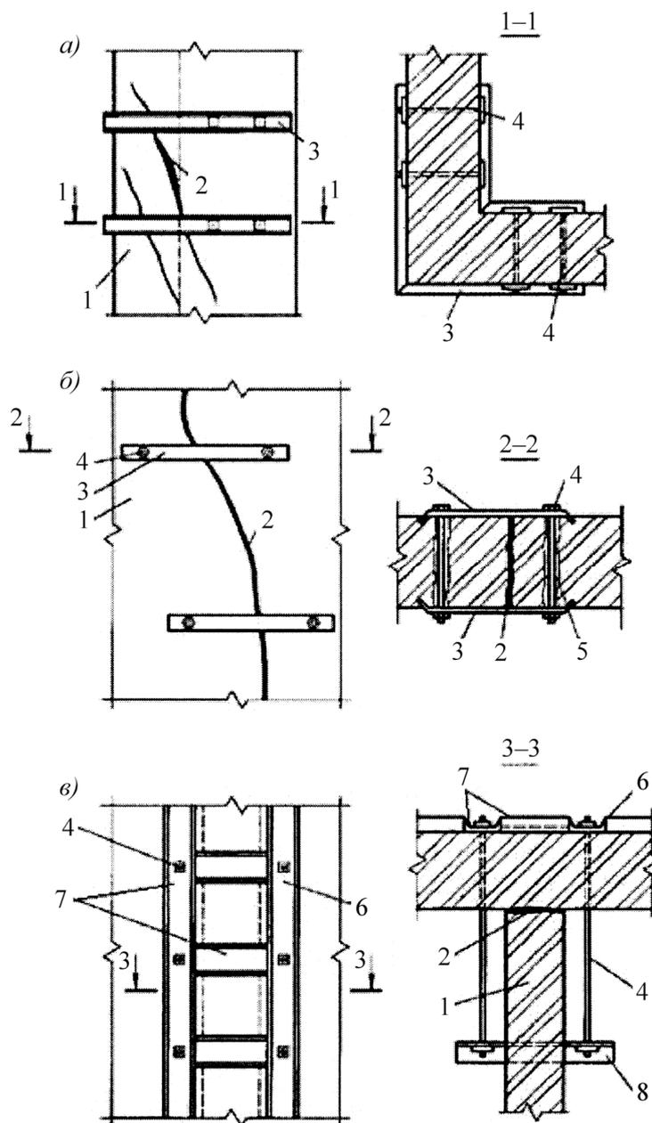
а), б) – стальными накладками; в) – стяжными болтами
