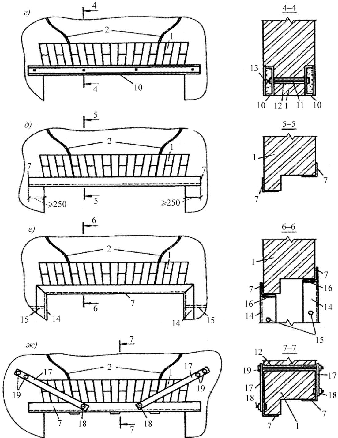
д), е) – с применением уголковых профилей; з) – балками из швеллеров; ж) – с использованием стальных подвесок; и) – арочным стальным листом
