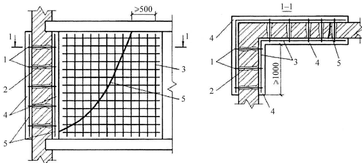
1 – анкеры  $\varnothing 6$  мм; 2 – отверстия в стене; 3 – арматурная сетка; 4 – торкретбетон; 5 – трещина в стене
