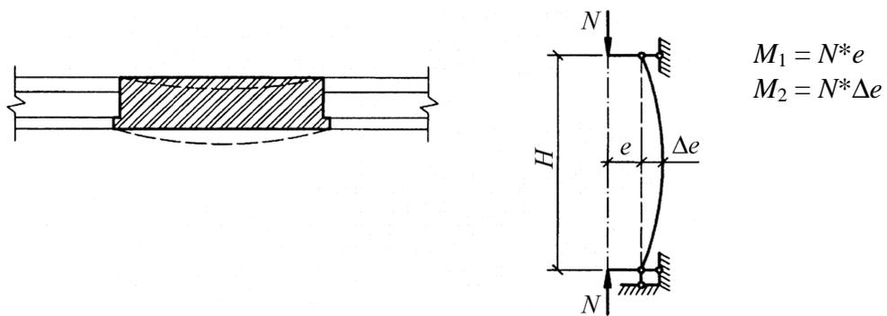
Рисунок 30 – Расчетная схема простенка при его выпучивании
