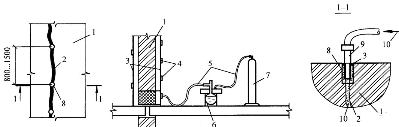
1 – усиливаемая стена; 2 – трещина; 3 – герметизация; 4 – шайбы; 5 – шланг; 6 – инъекционное устройство; 7 – баллон со сжатым воздухом; 8 – отверстия для установки инъекторов; 9 – инъекторы; 10 – инъекционный состав
