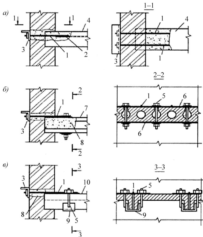
*a)* – балок; *б)* – пустотных плит; *в)* – ребристых плит
