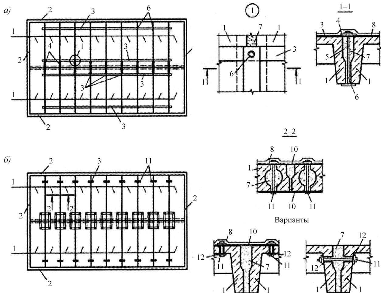
а) – соединением ребристых железобетонных панелей стальными поясами; б) – соединением панелей накладками на болтах
