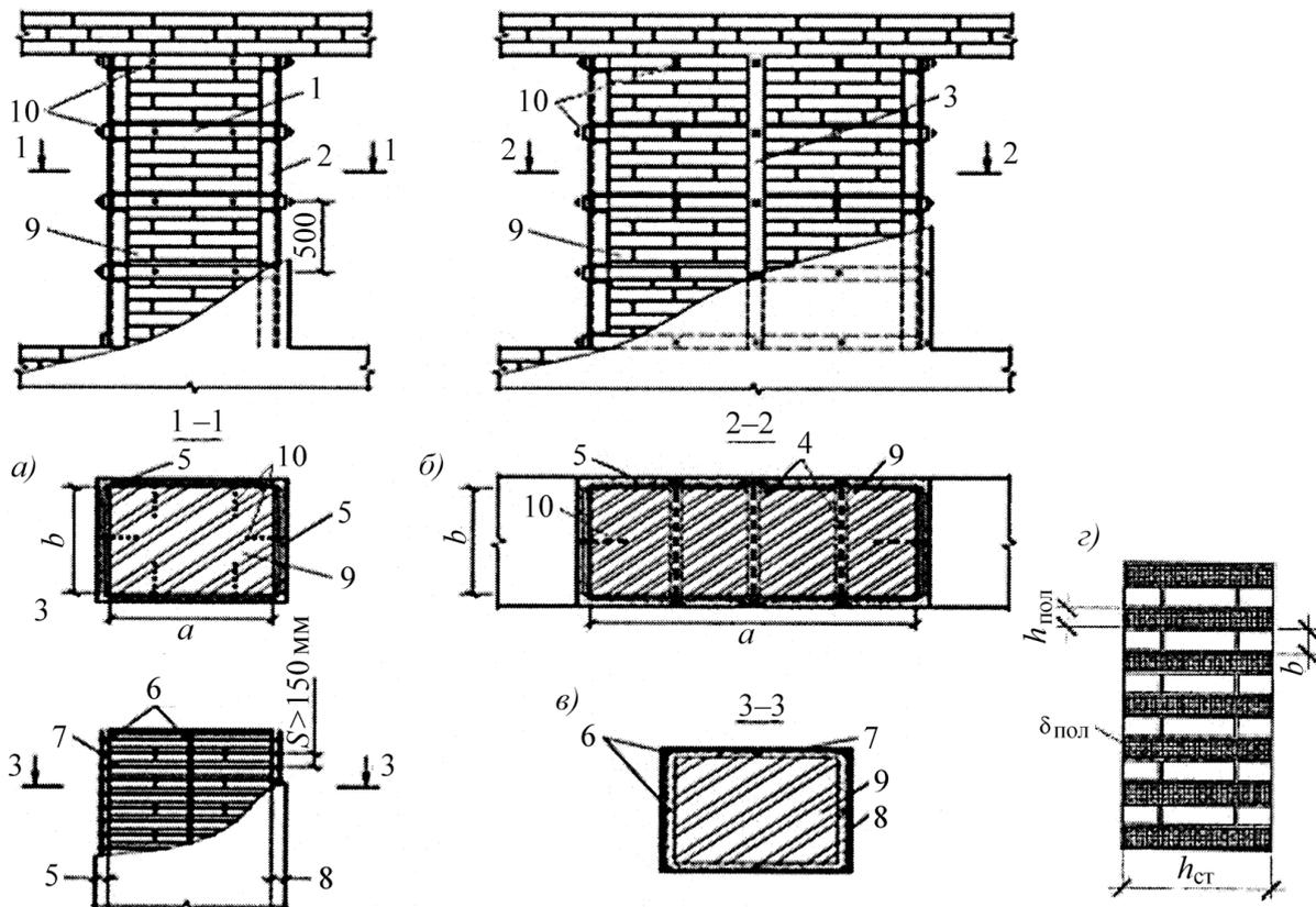
*a)* – стальной обоймой при соотношении сторон сечения меньше 1:2; *б)* – стальной обоймой при соотношении сторон сечения больше 1:2; *в)* – железобетонной или армированной растворной обоймой; *г)* – полотном из углеродного волокна
