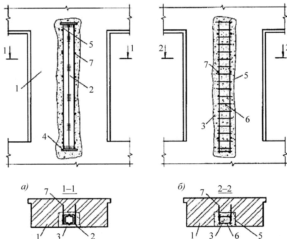
*а)* – устройство сварного из двух швеллеров; *б)* – устройство железобетонного сердечника
