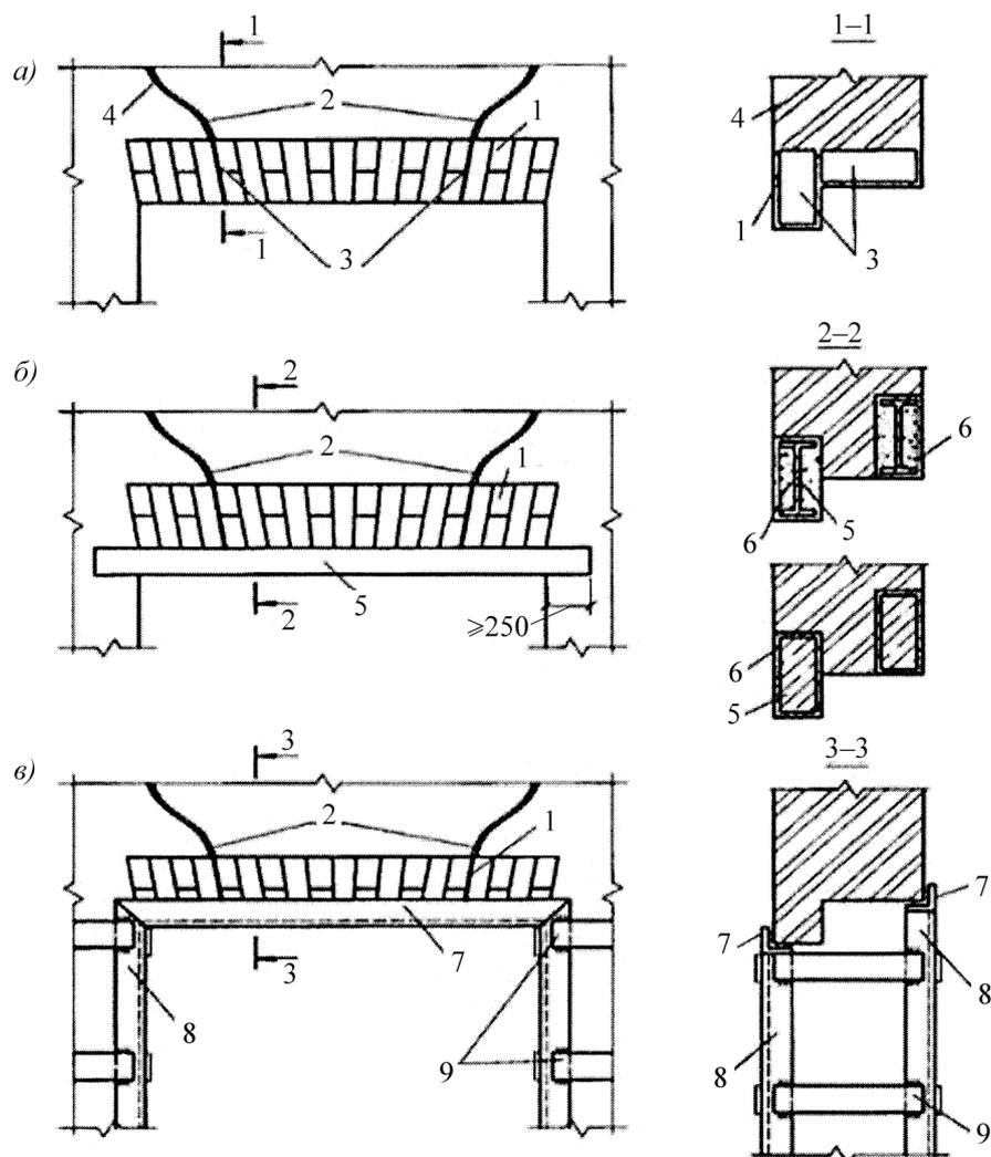
а) – заделкой трещин; б) – заменой на железобетонные или металлические; в) – с применением уголковых профилей
