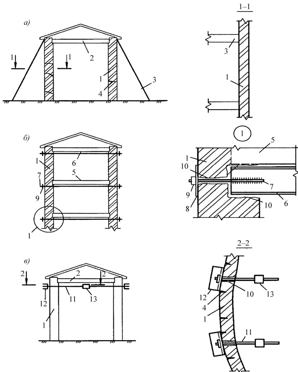
*a*) – возведением контрфорсов; *б*) – установкой поэтажных связей-распорок; *в*) – установкой металлических тяжей
