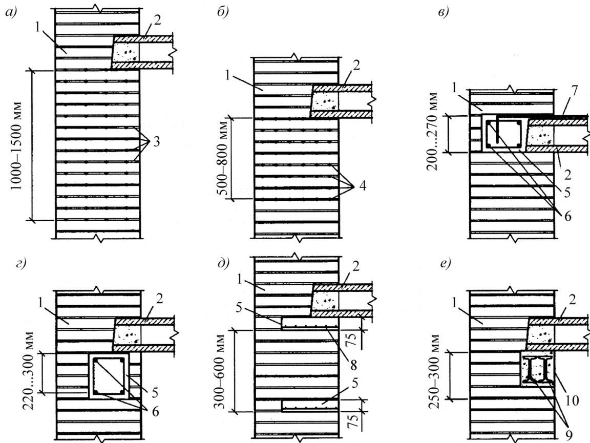
*а)* – армированием горизонтальных швов сетками; *б)* – размещением в горизонтальных швах арматурных стержней; *в)* – устройством железобетонных поясов в одном уровне с перекрытием; *з), д)* – то же в уровне низа перекрытия; *е)* – установкой стальных прокатных балок
