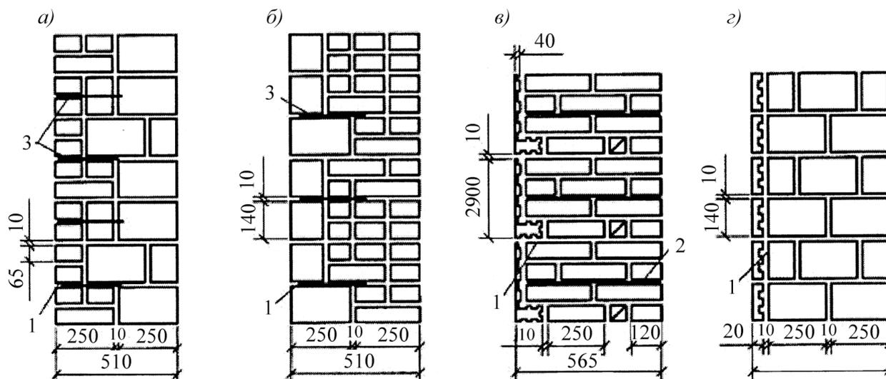
*а*) – лицевым кирпичом стены из керамических камней; *б*) – лицевыми керамическими камнями стены из кирпича; *в*) – закладными керамическими плитами стены из кирпича; *з*) – прислонными керамическими плитами стены из керамических камней
