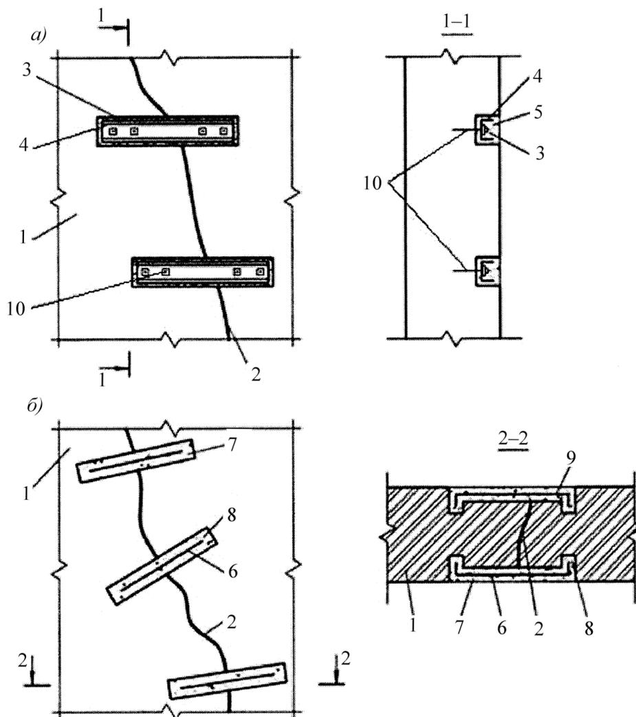
а) – установкой шпонок из прокатного металла; б) – то же скоб из арматурных стержней
